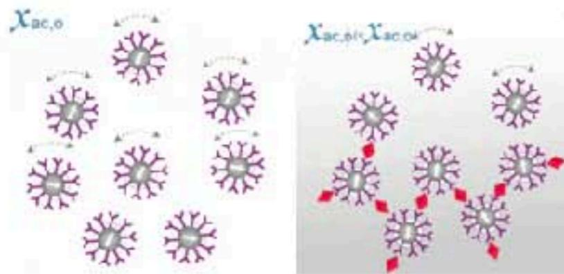
免疫磁減量檢測 (IMR) 原理如左圖所示，乃是利用分散在水中之披覆有生物探針的磁性粒子與待測生物分子結合後，形成磁性粒子叢集 (magnetic cluster) 或造成磁性粒子變大變重，再藉由量測因這些磁性粒子叢集或大磁性粒子的形成而改變試劑磁性大小，以探知待測生物分子濃度的新穎檢測方式。生物探針的選擇是使用與待測生物分子具高專一性及強力結合性的抗體或抗原。該磁性試劑在外加交流磁場下，所發出的混頻交流磁訊號 ( $x_{ac}$ )
